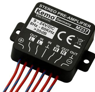
Preamplificador estéreo universal para micrófonos y aplicación universal. El módulo se conecta simplemente entre un amplificador final estéreo y una fuente de señal demasiado débil (por ejemplo, un micrófono).
