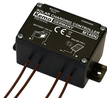
Conectar este regulador de carga solar entre una célula solar 12 V/DC (tensión de circuito abierto 14 - 30 V/DC) y un acumulador 12 V/DC para evitar una sobrecarga del acumulador. Indicaciones LED para: "acumulador lleno" (BATTERY FULL) (aprox. 14,4 V/DC) y "cargando" (CHARGING).
