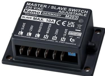
Conecta automáticamente una otra carga (slave) al enchufar una máquina, lámpara, etc. (master). Potencia total master + slave 3680 W (16 A) como máximo, donde la potencia máxima „esclavo“ es de 2300 W (10 A). La sensibilidad de la carga master es ajustable.
