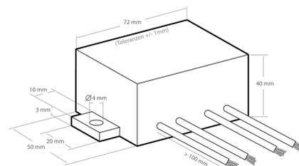
Прерыватель света с настройкой последовательности сигнала: приблизительно от 0,6 до 9 секунд. Время выключения: приблизительно 50% времени включения. Встроенный предохранитель: 1,6 Ампер медленного действия. Для ламп накаливания и светодиодных ламп, 10 - 300 Вт, 240 В переменного напряжения (10 - 150 Вт при 110 В / переменного напряжения).
