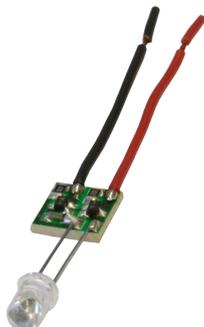
Этот индикатор с постоянным током электроники может быть спаян с любым напряжением между 4-30 V / постоянного тока связаны между собой.Индикатор всегда имеет такой же свет с током 15 mA. Существенно дополнительное сопротивление не требуется.В индикаторе можно обменять на любой другой светодиод. Кроме того, несколько светодиодов соединены последовательно.
