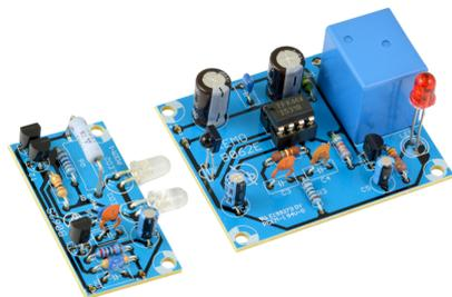
Световой барьер с невидимым инфракрасным светом. В комплект входят передатчик и приемник! Идеально подходит для систем сигнализации, автоматического фотографирования животных, как пульт дистанционного управления для гаражных ворот и т.д. оснащен инфракрасным фильтром для использования в дневное время суток!
