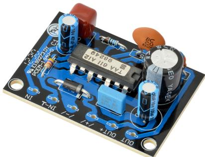
Маленький универсальный усилитель пиковой мощностью до 2 Ватт. Современный, недорогой усилитель для широкого спектра применения. Он собран на 8-ми ножечной микросхеме. Маленькие размеры усилителя позволяют его безпроблемную интеграцию во многие устройства. Корпус для монтажа: G027N - Пластиковый корпус чёрного цвета ок. 72 x 50 x 35 мм
