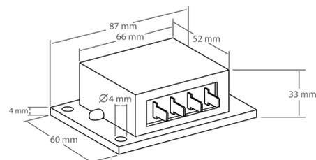
Модуль предназначен для регулировки омической + индуктивной нагрузки (напр. электродвигатели, отопление и т.д., в случаях, когда возможно воспользоваться регулировкой по фазовой отсечке).
