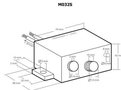
Данный модуль оснащен кабелем для подключения громкоговорителя и регулятором громкости, а так же соответствующими разъемами для подключения входного сигнала и источника питания.
