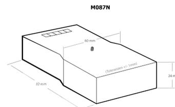
При помощи этого тестера вы можете проверить светодиод с ножками (LED) на функциональность, яркость, цвет и полярность. Для селекции светодиодов на яркость подготовлены два рядом стоящие измерительные гнезда с одинаковой величиной тока (5 мА/10 мА). Для питания необходимо применить: Алкалиновую батарейку 9 Вольт (Крона).
