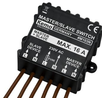
При включении машины, лампы и т.д. автоматически включает другую нагрузку, а при их выключении автоматически эту нагрузку отключает. Возможен контроль однофазных или трёхфазных машин (у трёхфазных машин контролируется только одна фаза). К выходу можно подключить однофазный прибор (напр. пылесос), (или трёхфазную нагрузку посредством вспомогательного реле, к поставке не прикладывается). Максимальный ток: 15 А для мастера или слейва, общая мощность 3600 Ватт (Мастер+Слейв).
