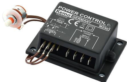
Для потребителей переменного тока 230 В таких, как электромоторы, лампы и т.д. Регулятор устойчив к перегрузкам и может управляться потенциометром (100 кОм линейный), управляющим напряжением (0 - 10 В) или ШИМ-сигналами (0 - 100% , 100 - 10.000 Гц).
